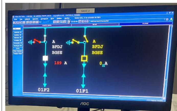
Figura 7 – Esquerda: Tela do SAGE com o IED ABB sem comunicar (antes da intercambialidade). Direita: Tela do SAGE com o IED SEL comunicando (depois da intercambialidade).
